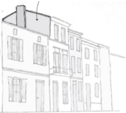
Mur pignon visible depuis l'espace public
